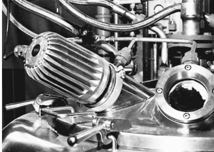
Oprawa oświetleniowa CHEMLUX® typu P 20 dH Sch, 20 W, 230 V, Ex de IIC T5, Ex tD A21 IP65 T95 ° C, Ex II 2 G + D, z mocowaniem "Sch" na wirówce koszowej
