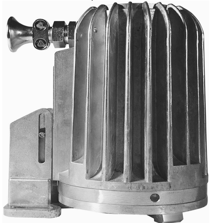
Typ L 20 deH Sch sp, 20 W, 240 V, Ex d IIC T5, Ex tD A21 IP65 T95°C, Ex II 2 G + D, z uchylnym zawiasem "Sch"
