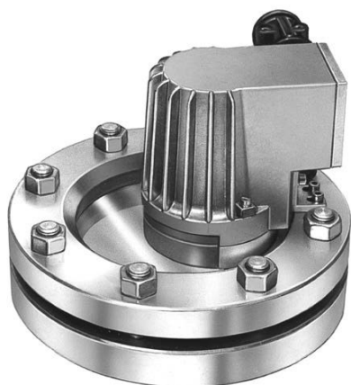
Strefa niebezpieczna typu KEL de PowerLED W, Ex de op to IIC T6 Gb, Ex tb IIIC T80 ° C Db, IP65 / 67, Ex II 2 G + D, 230-240 V AC, 7 W, zamontowany na wzierniku wg DIN 28120, DN 125, PN 10, w wersji 1-portowej.
