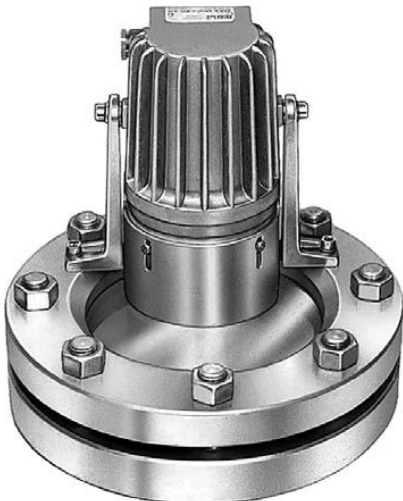
Strefa bezpieczna typu KL PowerLED Sch B 24 V AC/DC, 7 W, z osłoną zamontowany na wzierniku wg DIN 28120, DN 100, PN 10, w wersji „światło i widok”.
