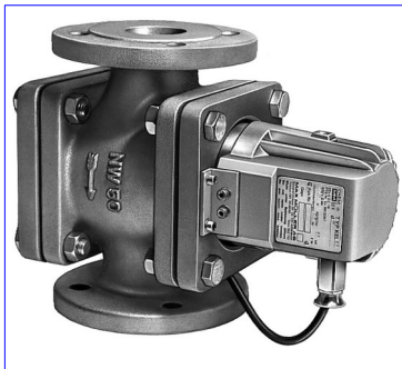
Oprawa do stref bezpiecznych Typ FKEL 5 dH WM, Ex d IIC T6, Ex tD A21 IP65 T80 ° C, Ex II 2 G + D, 230V, 5W, szkło opalowe "M", na wskaźniku przepływu DN 50.
