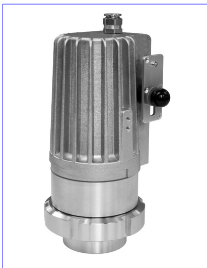
Typ FHEL 35 dHVRK1, Ex d IIC T4, Ex tD A21 IP65 T130°C Ex II 2 G + D, 230 V, 35 W, Halogen, z timerem "V" na skręca- nym wzmniku podobnym do DIN 11851, DN 65, PN 6. Mocowanie z kołnierzem pośrednim "R".
