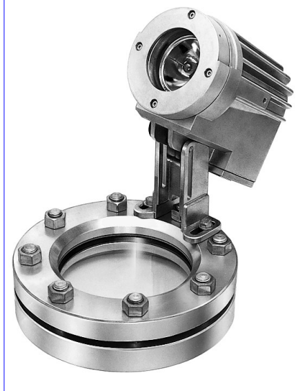
Typ PEL 20 DEH Sch, 230 V, 20 W, Ex de IIC T6, Ex tD A21 IP65 T80 ° C, Ex II 2 G + D, zamontowany na okrągłym wzierniku wg DIN 28120, DN 125, PN 10, w wersji dla portu 1
