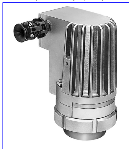
Typ PL 100 HR80, 24 V, 100 W, na skręcanym wżerniku podobnym do DIN 11851, DN 80, PN 6. Kołnierz pośredni "R"
