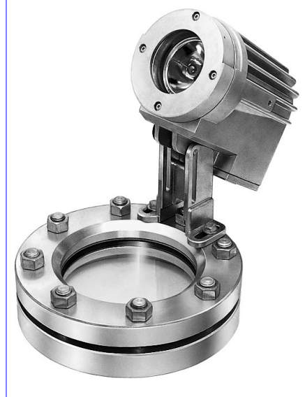
Typ PEL 20 DEH Sch, 230 V, 20 W, Ex de IIC T6, Ex tD A21 IP65 T80 °C, Ex II 2 G + D, zamontowany na okrągłym wżerniku wg DIN 28120, DN 125, PN 10, w wersji dla portu 1
