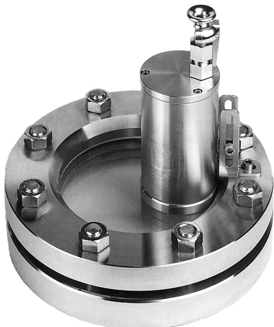
Oprawa oświetleniowa Typ EdelEx 20 dH Sch K1, 20W, 24V, Ex d IIC T4, Ex tD A21 IP65 T130°C, Ex II 2 G + D, montowana na wzierniku wg DIN 28120, PN 10, DN 125
