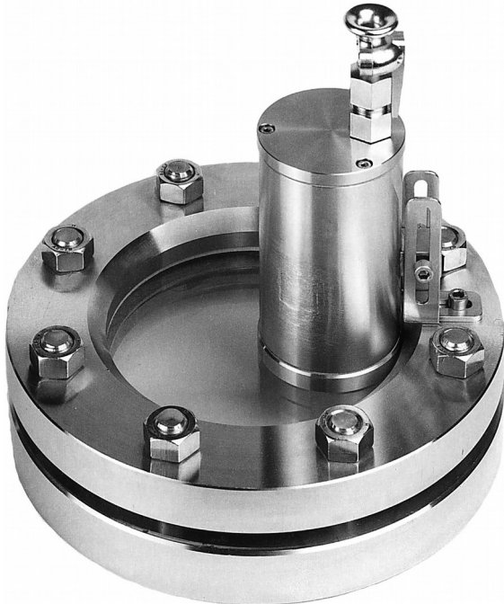
Oprawa oświetleniowa Typ EdelEx 20 dH Sch K1, 20W, 24V, Ex d IIC T4, Ex tD A21 IP65 T130°C, Ex II 2 G + D, montowana na wzierniku wg DIN 28120, PN 10, DN 125
