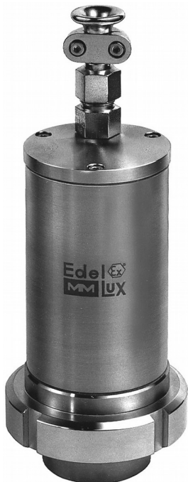
Oprawa oświetleniowa Typ EdelEx 10 dH R50 K1, 10W, 230V, Ex d IIC T4, Ex tD A21 IP65 T130 ° C, Ex II 2 G + D, z kołnierzem pośrednim, mocowanie kołnierza "R", montowane na skręcanym wzierniku podobnym do DIN 11851, PN 6, DN 50.
