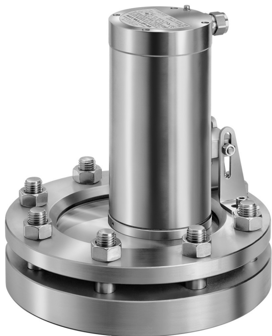
Oprawa oświetleniowa Typ EdelEx 50 dH Sch K2, 50W, 230V, Ex d IIC T4, Ex tD A21 IP65 T130°C, Ex II 2 G + D, montowana na wzierniku wg DIN 28120, PN 10, DN 150
