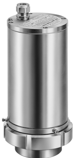
Oprawa oświetleniowa Typ EdelEx G20 dH R80 K1, 20W, 230V, Ex d IIC T5, Ex tD A21 IP65 T95 ° C, Ex II 2 G + D, z kołnierzem pośrednim, mocowanie kołnierza "R 80", montowane na skręca- nym wzierniku podobnym do DIN 11851, PN 6, DN 80.
