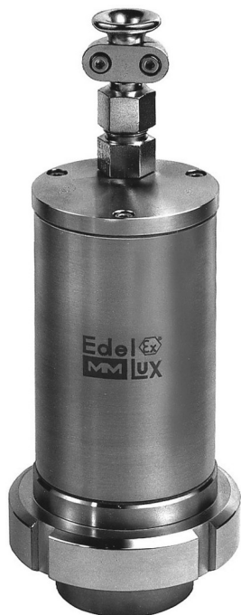
Oprawa oświetleniowa Typ EdelEx d LED R50 K1, ok. 2W, 24V, Ex d IIC T6, Ex tD A21 IP65 T80 ° C, Ex II 2 G + D, z kołnierzem pośrednim, mocowanie kołnierza "R", montowane na skręcanym wzierniku podobnym do DIN 11851, PN 6, DN 65.
