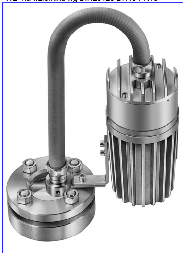
Oświetlenie światłowodowe z wbudowanym timerem "U", typ Fibrolux® 5035 W W2 U sp, Ex de IIC T4 Ex tD A21 IP65 T130°C, Ex II 2 G+D 35 W 12V DC, mocowanie źródła światła na wsporniku "W" światłowód mocowany za pomocą uniwersalnego uchwyty "W2" na wzierniku wg DIN28120 DN40 PN10
