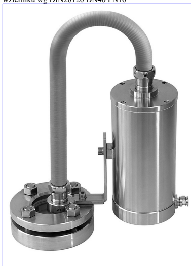
Oświetlenie światłowodowe Fibrolux® E 5035 W W2 sp, Ex d IIC T4, Ex tD A21 IP65 T130 ° C, Ex II 2 G + D, 35 W, 12 V DC, mocowanie źródła światła na wsporniku "W" światłowód mocowany za pomocą uniwersalnego uchwyty "W2" na wzierniku wg DIN28120 DN40 PN10
