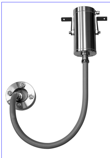
Oświetlenie światłowodowe do stosowania w obszarach niebezpiecznych Fibrolux® E 5035 X1 W2, Ex d IIC T4, Ex tD A21 IP65 T130 ° C, Ex II 2 G + D, 35 W, 230 V, mocowanie źródła światła stopa "X1", mocowanie światłowodu za pomocą uniwersalnego uchwyty "W2" na wzierniku wg DIN28120 DN40 PN10
