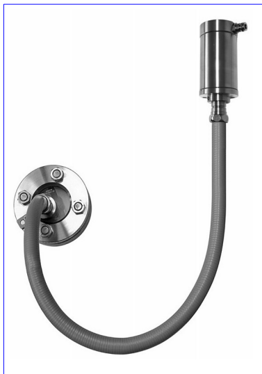
Oprawa oświetleniowa ze światłowodem ze stali nierdzewnej do stosowania w obszarach zagrożonych wybuchem, typ fibroLUX E d PowerLED Sch W2 K2, Ex II 2 G + D, 7 W, 230-240 V AC, mocowanie źródła światła z zawiasem przechylnym "Sch", mocowanie lampy przez uniwersalne podparcie "W2" na wzierniku wg DIN 28120, DN 40, PN 10
