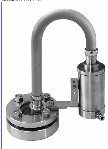
Oprawa oświetleniowa ze światłowodem ze stali nierdzewnej, typ fibroLUX E d PowerLED W2 K2, Ex II 2 G + D, 7 W, 24 V AC / DC, mocowanie źródła światła ze wspornikiem "W", mocowanie lampy na uniwersalnym wsporniku "W2" na wzierniku wg DIN28120, DN 40, PN 10
