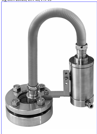
Oprawa oświetleniowa ze światłowodem ze stali nierdzewnej, typ fibroLUX E d PowerLED W W2 K2, Ex II 2 G + D, 7 W, 24 V AC / DC, mocowanie źródła światła ze wspornikiem "W", mocowanie lampy na uniwersalnym wsporniku "W2" na wzierniku wg DIN 28120, DN 40, PN 10
