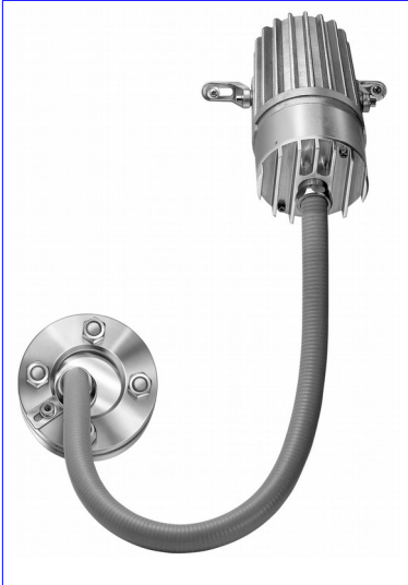
Oświetlenie światłowodowe do stosowania w obszarach niebezpiecznych z wbudowanym timerem "V", typu Fibrolux® 5035 X1 W2 V, Ex de IIC T4, Ex tD A21 IP65 T130°C, Ex II 2 G + D, 35 W, 230 V mocowanie źródła światła stopa "X1", mocowanie światłowodu za pomocą uniwersalnego uchwyty "W2" na wzierniku wg DIN28120 DN40 PN10
