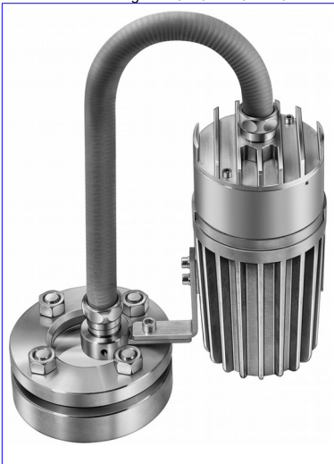
Oświetlenie światłowodowe z wbudowanym timerem "U", typ Fibrolux® 5035 W W2 U sp, Ex de IIC T4 Ex tD A21 IP65 T130°C, Ex II 2 G+D 35 W 12V DC, mocowanie źródła światła na wsporniku "W" światłowód mocowany za pomocą uniwersalnego uchwyty "W2" na wzierniku wg DIN28120 DN40 PN10
