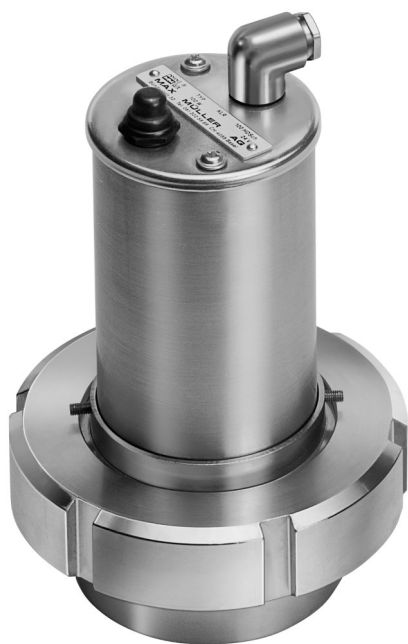
Oprawa oświetleniowa typ KLR PowerLED D R80 K2, 7 W, 24 V AC/DC, z wbudowanym przyciskiem czasowym "D", zamontowany z kołnierzem "R 80" na skręcanym wzierniku podobnym do DIN 11851, DN 80, PN 6
