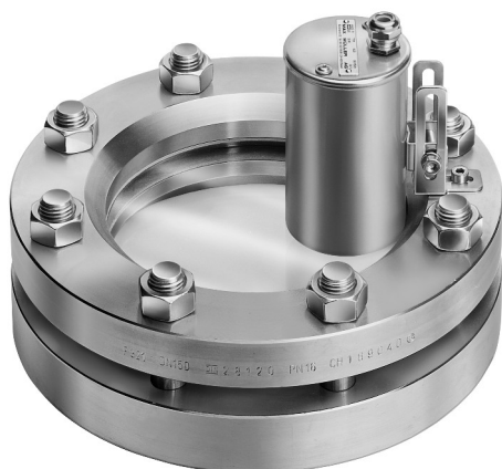
Oprawa oświetleniowa typ KLR PowerLED 7W, 24 V, zamontowana z uchylnym zawiasem "SCH" na wzierniku DIN 28120, DN 150, PN 10, "widok i światło poprzez jeden zespół "
