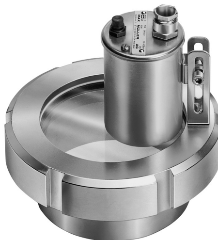
Oprawa oświetleniowa BKVLR LED DSch1 24V z wbudowanym przyciskiem czasowym "D", zamontowana z uchylnym zawiasem "Sch1" na skręcanych wzierniku podobnym do DIN 11851, DN 100, PN 6, dla aplikacji "widok i światło przez jeden zespół"
