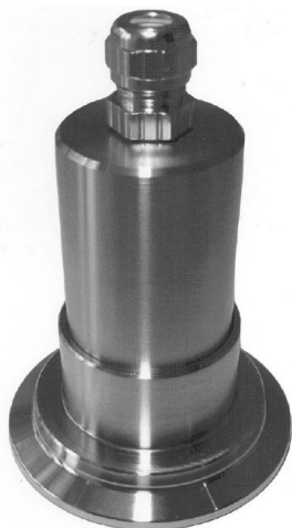
Oprawa oświetleniowa Micro LED, TYP MVL R 2 LED , 2 W, 24 V AC / DC, zamontowana na metalowym wzierniku „Fused” TriClamp ® złącza DN50 PN1
