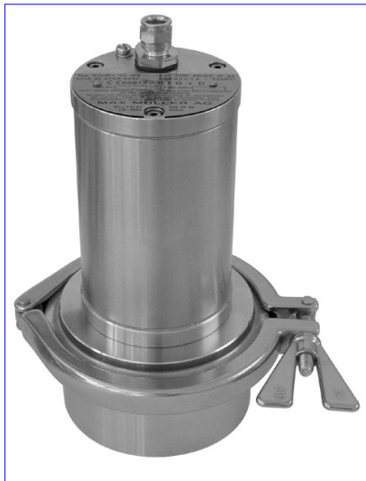
Oprawa wziernikowa typu EdelEx Steri-LINE 20 dH, 24 V, 20 W, Ex d IIC T4 Gb Ex t IIIC T130°C Db IP67, Ex II 2 G + D, na MetaFuzed wzierniku DN 100
