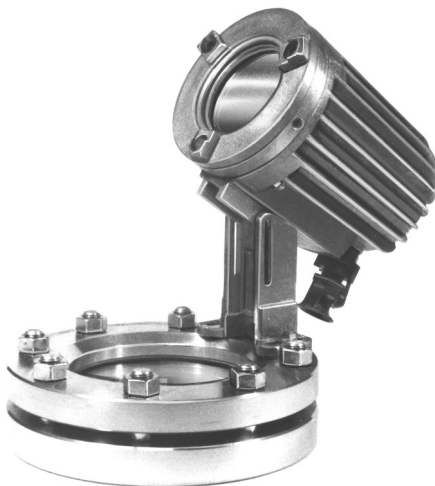
Wziernik flanszowy wg DIN28120, DN100 PN10 Z hartowanym sodowkrzemowym dyskiem szklanym DIN 8902 wyposażony w oprawę oświetleniową CHEMLUX®, typu L 20 deH Sch, z uchylnym zawiasem.
