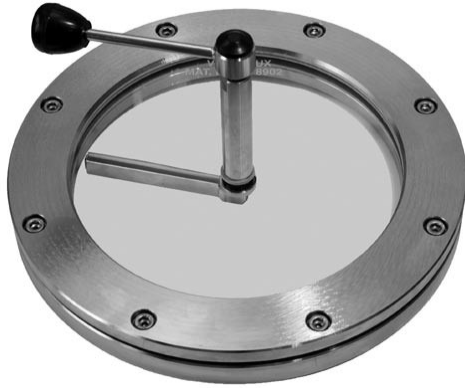
Wziernik podobny do DIN28120, DN 150, PN 0, Z sodowokrzemowym dyskiem szklanym wg DIN 8902 Wycieraczka z serii W. Pióro wycieraczki Silikon
