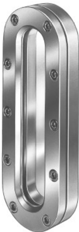
Wziernik wydłużony zaokrąglony, typ LSGRR 316 Ti - 304 -2,5-2-SL-8903-Klingsil-silikon. Wersja z otworami gwintowanymi Imbus. Kołnierze ze stali nierdzewnej, PN 2,5, dysk szklany DIN 8903, uszczelki Klingsil C4400 / silikon, wymiary 341 x 116 mm.
