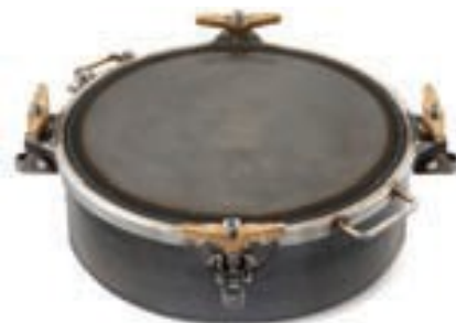
Właz ciśnieniowy Typ „B” Ø 500 mm 4-6 bar Z flanszą kompensacyjną
