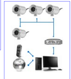
▲ Powyżej Mały system do lokalnego monitoringu ► Prawy Duży system do globalnego monitoringu
